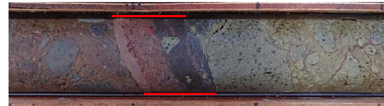
コア写真(FK-1孔, 断層付近拡大) 〓 破碎部
