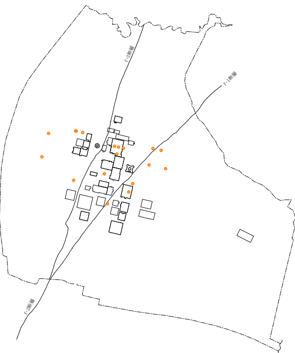
六ヶ所層の物性値算定に用いるボーリング調査孔位置
