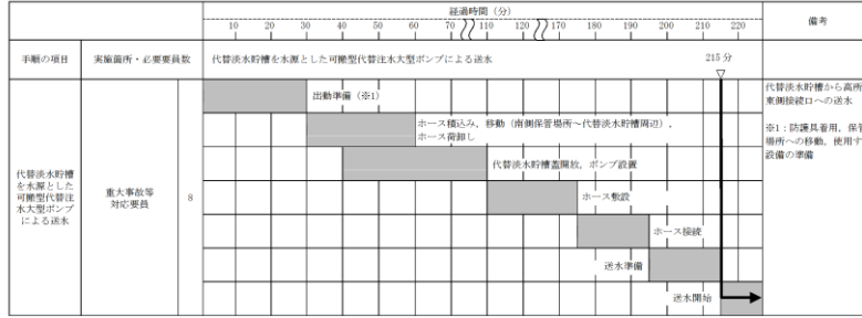
【ホース敷設にホース運搬車を使用する場合、高所東側接続口への送水開始まで 170 分以内で可能である。】
