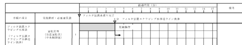
第 1.5-13 図 フィルタ装置スクラビング水移送 タイムチャート (2/2)
