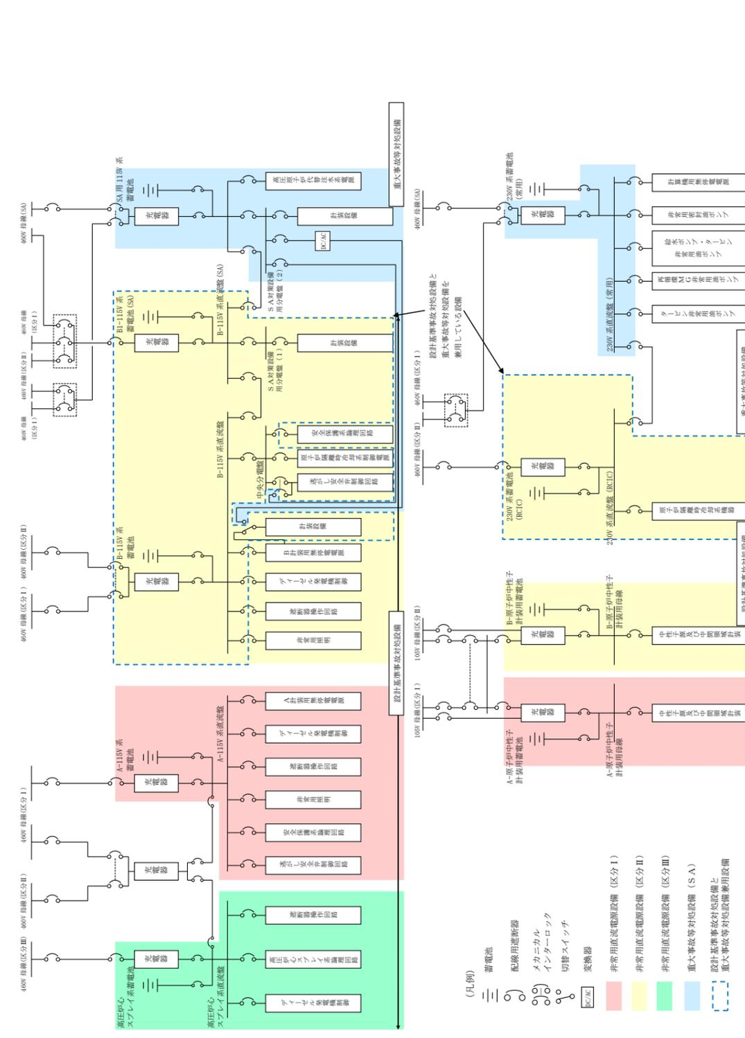
第 57-10-1 図 直流電源設備系統図
