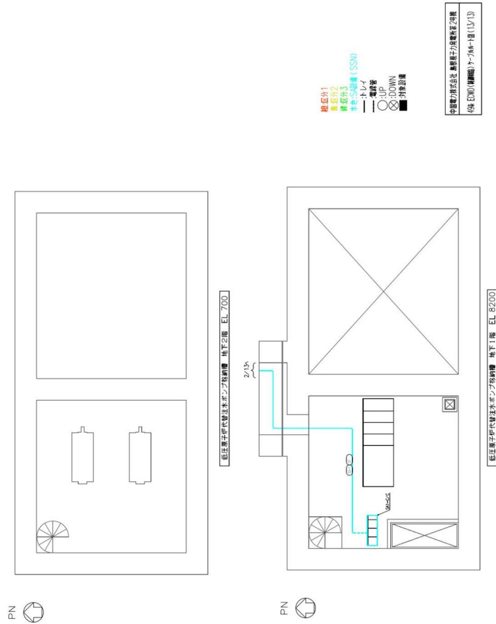
第 49-33 図 低圧原子炉代替注水ポンプ格納槽 地下2階及び地下1階
