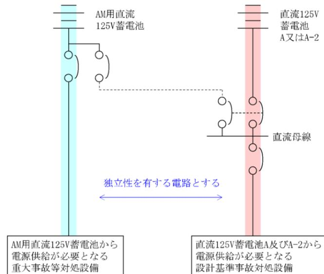
図 57-10-3 直流電源供給方法
