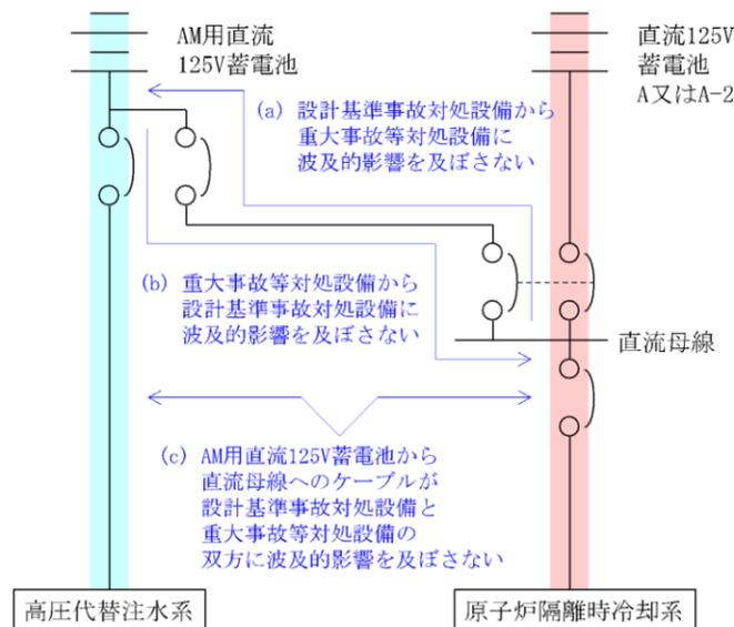
図 57-10-5 直流電源供給 (原子炉隔離時冷却系)
