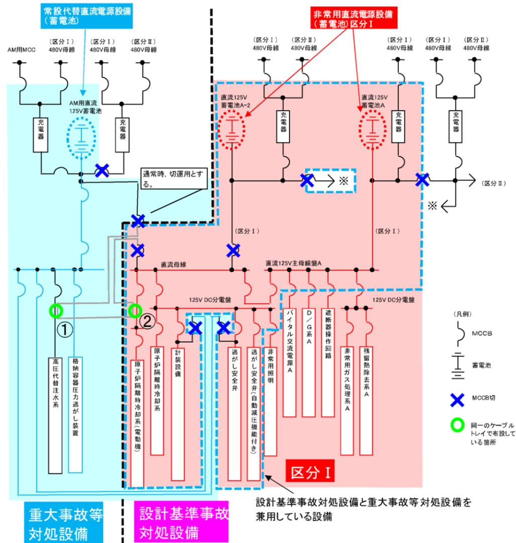
図 57-10-10 配線用遮断器の運用方法 (7号炉)
