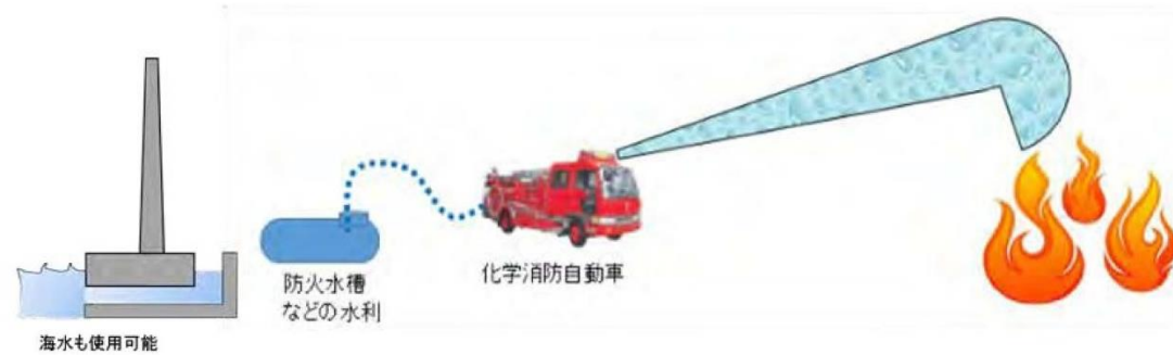
図 8-2 化学消防自動車による泡消火
