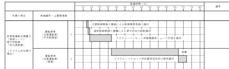
第 3.1-5 図 原子炉の緊急停止対応タイムチャート*
