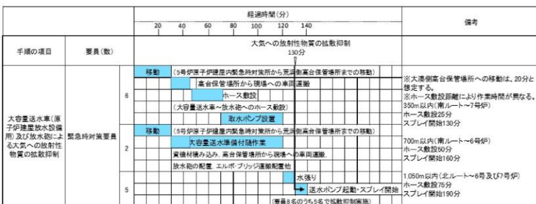
図 3.12-5 大気への放射性物質の拡散抑制のタイムチャート※
