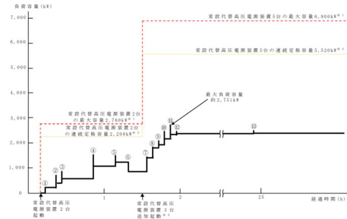
※1 常設代替高压電源装置定格出力運転時の容量(1,380kW×運転台数=最大容量)
