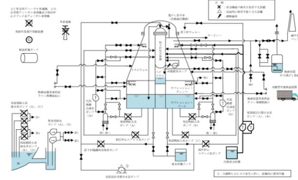
第3.1.2-1 図 「雰囲気圧力・温度による静的負荷(格納容器過圧・過温破損)」の重大事故等対策の概略系統図
