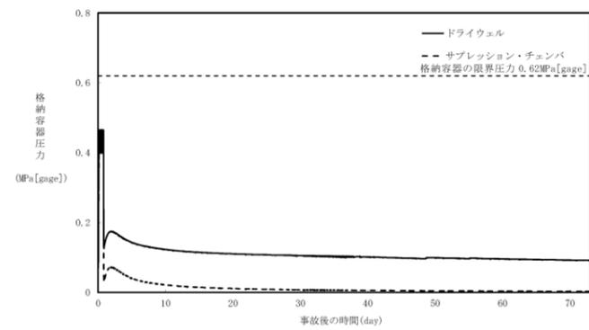
第4図 雰囲気圧力・温度による静的負荷（格納容器過圧・過温
