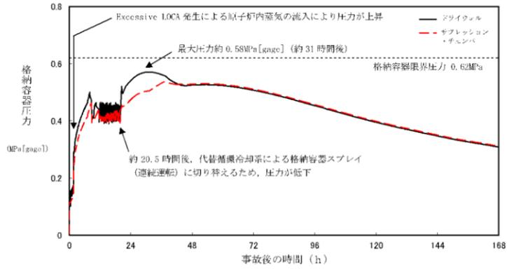
図1 格納容器圧力の推移
