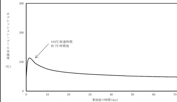
第3図 雰囲気圧力・温度による静的負荷 (格納容器過圧・過温破損)
