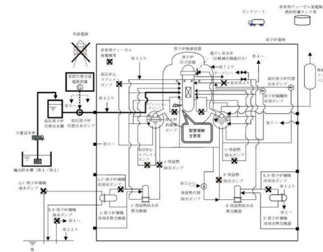
第3.1.2.1-1(1) 図 「雰囲気圧力・温度による静的負荷(格納容器過圧・過温破損)」の重大事故等対策の概略系統図
