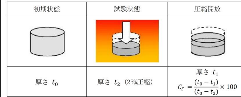
図2 圧縮永久ひずみの算出概念図
