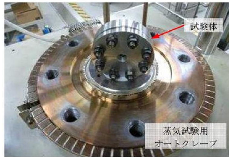
第4図 蒸気暴露試験体設置状況
