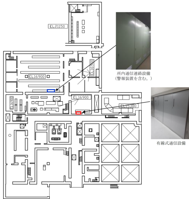
参考第 12.1-3 図 主要な通信連絡設備の配置図 (廃棄物処理建物 1 階)
