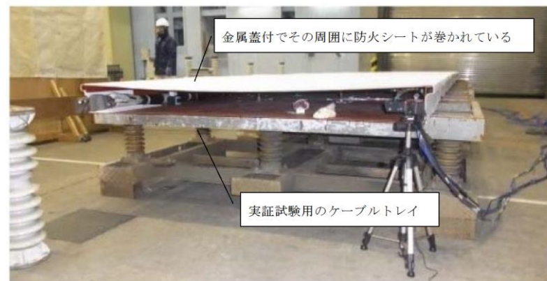
第 3 図 実証試験用のケーブルトレイ
