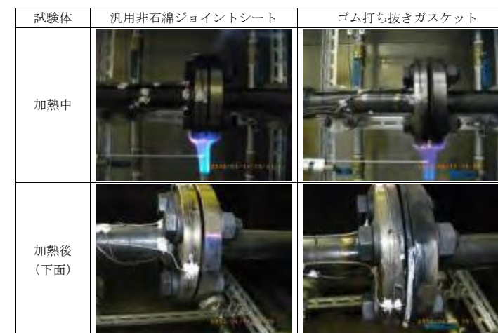
第2図 試験体の加熱状況
