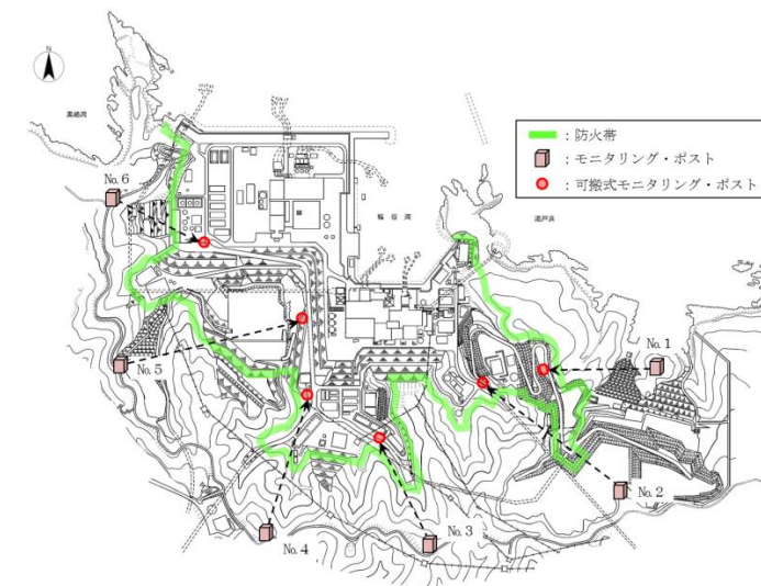
第2.3.3-2図 可搬式モニタリング・ポスト設置位置
