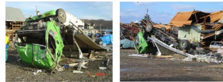
図33 竜巻による被災後の4tトラックの様子<sup>(24)</sup><sup>(25)</sup>
