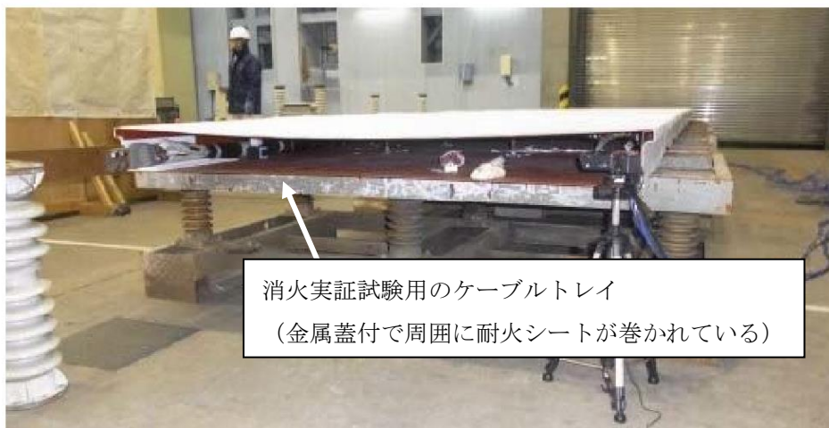
第3図 消火実証試験用のケーブルトレイ外観
