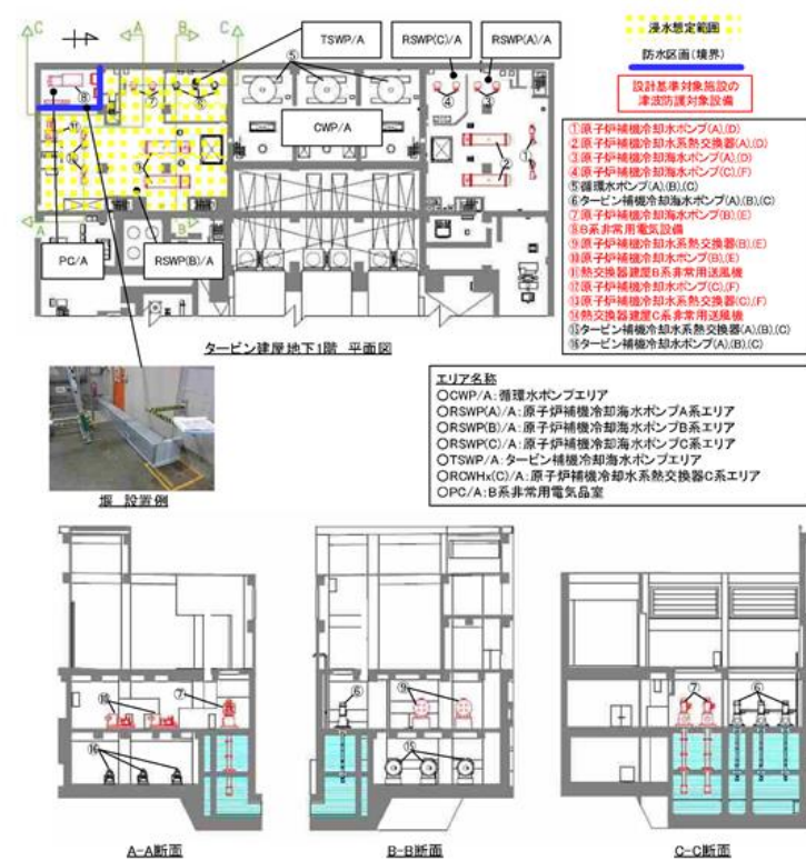
第2.3-9図 浸水想定範囲 (RSWP(B)/A及びTSWP/A) に対する防水区画化範囲 (6号炉の例)
