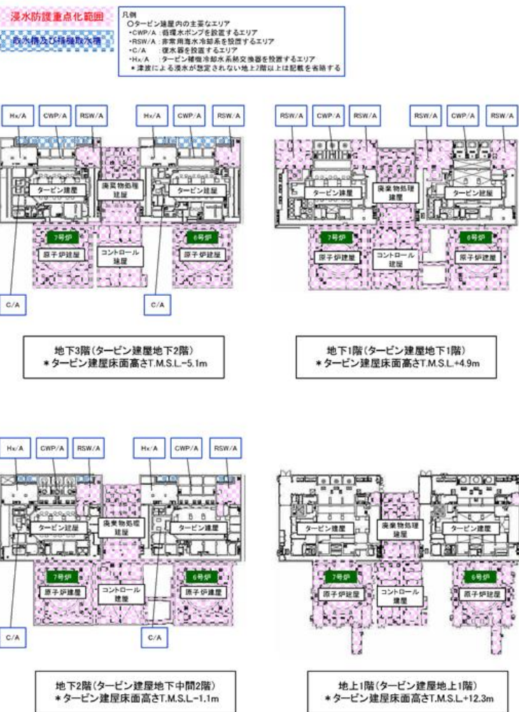
図 2.4-2 2号炉 建屋・復水貯蔵タンク・軽油タンクエリア断面図及び浸水防護重点化範囲 (南北方向)
