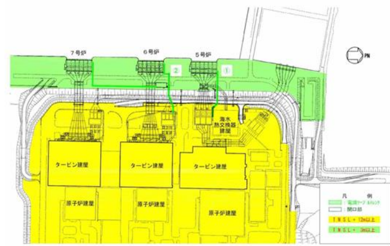
第2.2-6-1図 電源ケーブルトレンチ配置図
