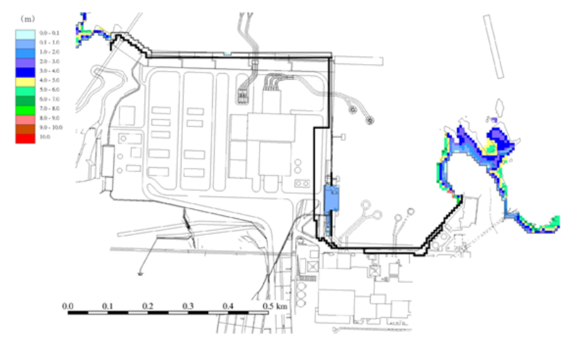
第1.3-2図 基準津波による遡上波の最大浸水深分布 (基準津波1：防波堤無し)
