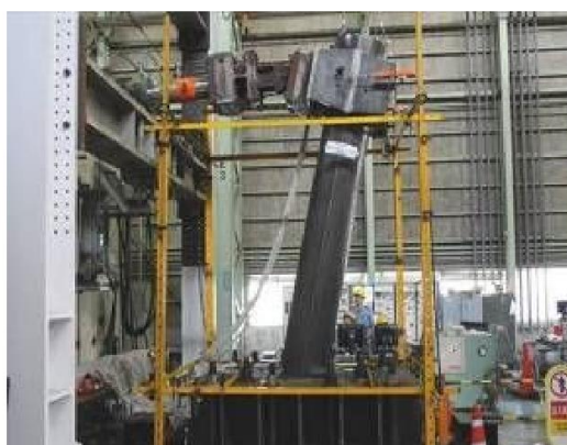
第 5-38 図 最大荷重時座屈状況
