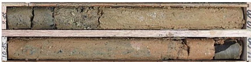
第2-10 図 採取した埋戻土（粘性土）
