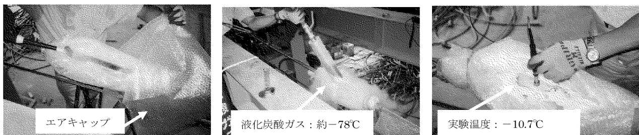
図 5 凍結試験の条件設定状況
