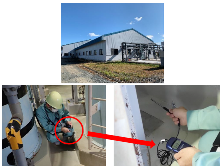
図4 タンク周りの風速及び温度の測定状況 (第2一般排水処理建屋)
