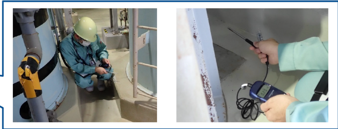
タンク周りの風速及び温度の測定状況（第2一般排水処理建屋）
