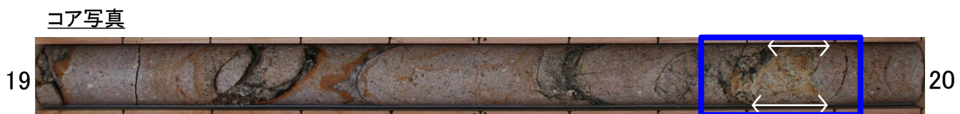
深度19.87mのフィルム状の細粒部
