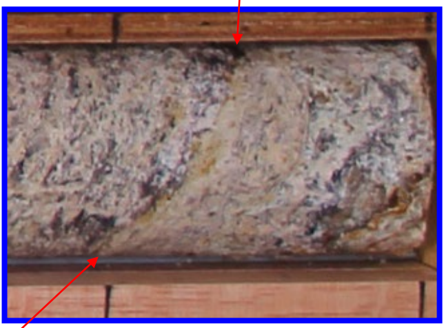
青枠部拡大 0 5 cm 深度35.92mの半固結状の粘土
