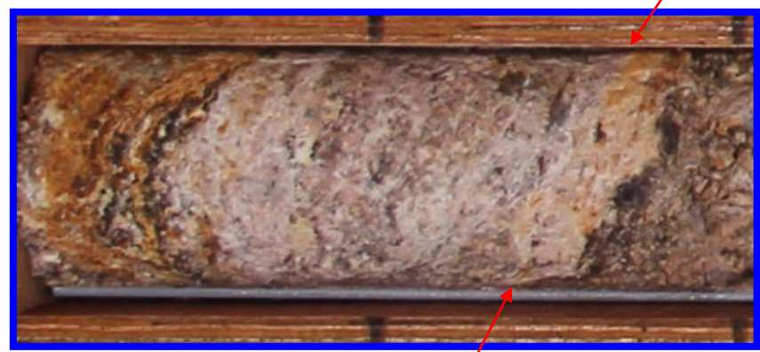
深度46.17mの半固結状の粘土
