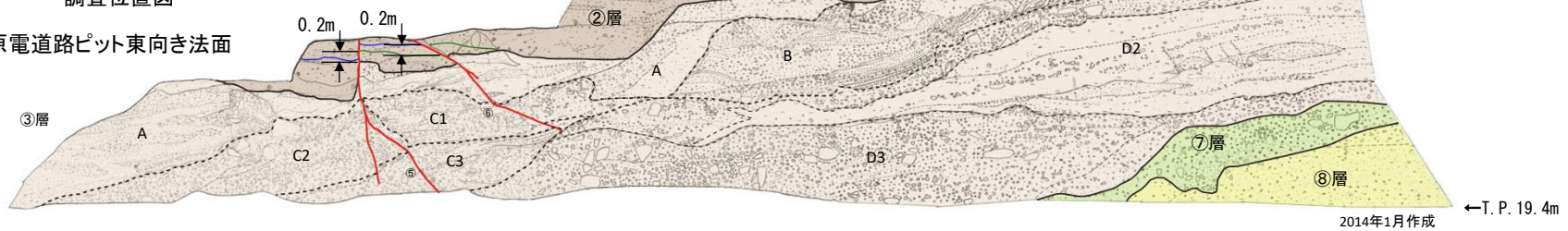
原電道路ピット島状頂盤部 (T.P.19.4m)
