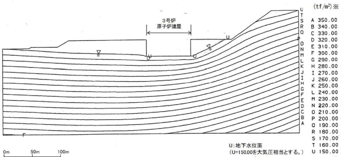
補足 2-31 図 間隙水压分布図(H-H' 断面)
