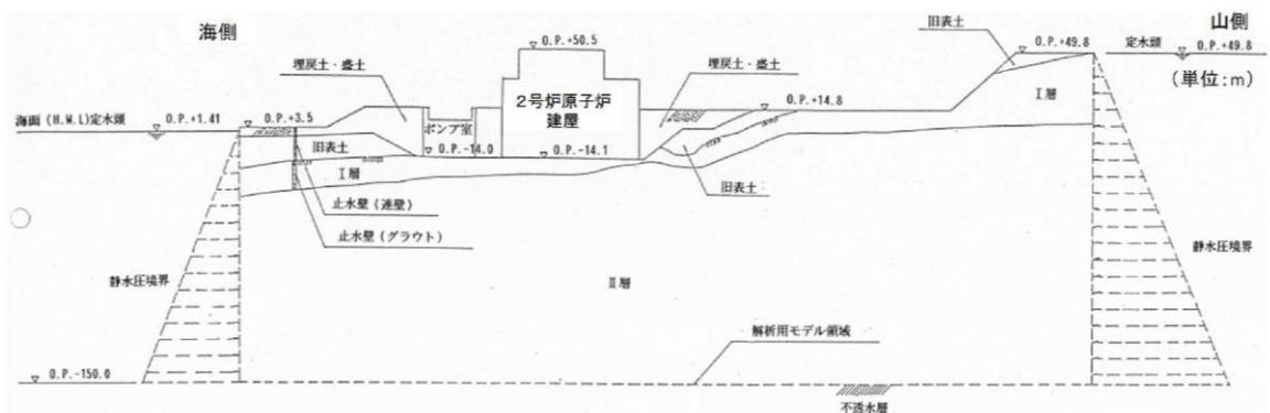
補足 2-14 図 浸透流解析断面図(C-C' 断面)
