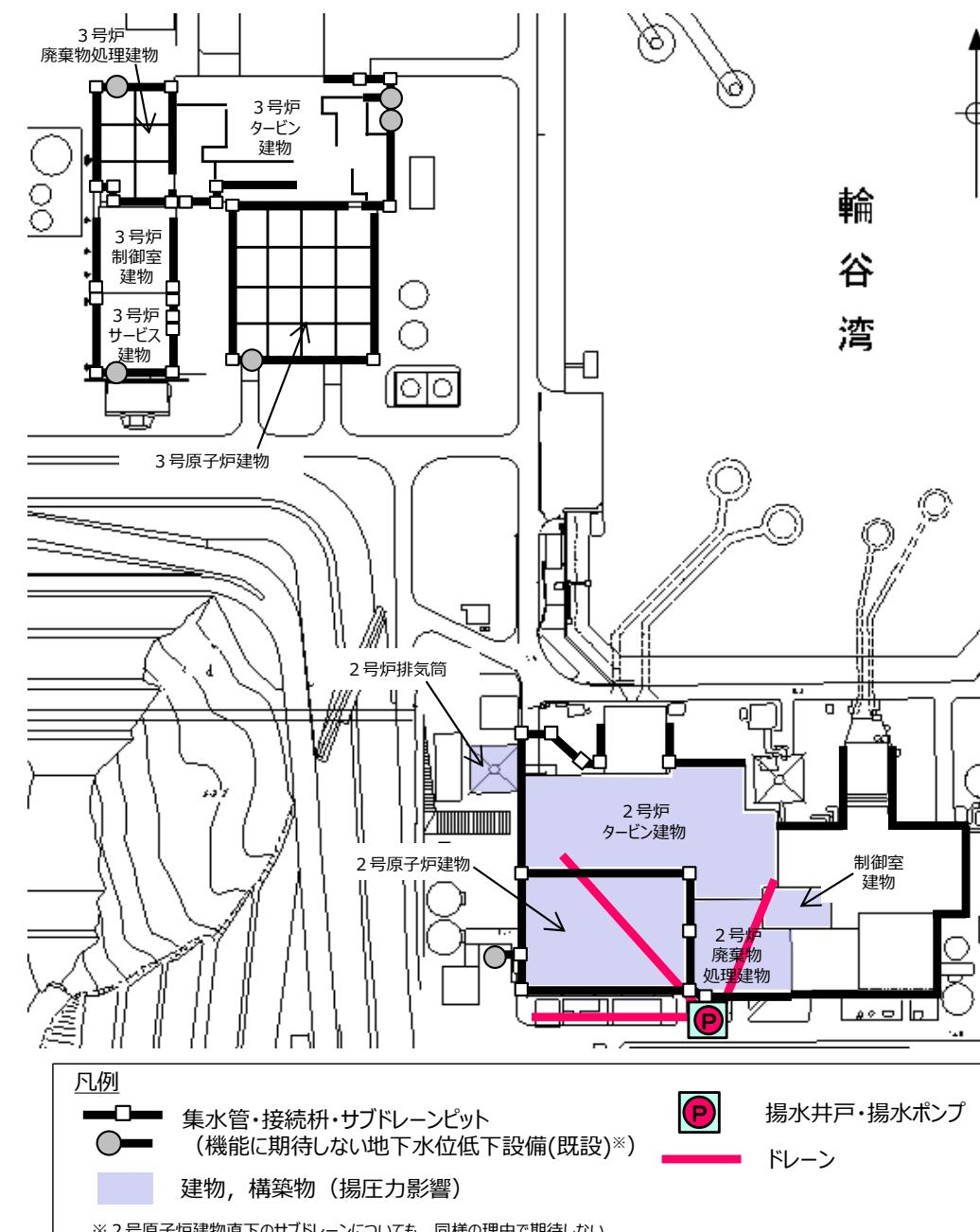
添付 1-3 図 地下水位低下設備の設定例
