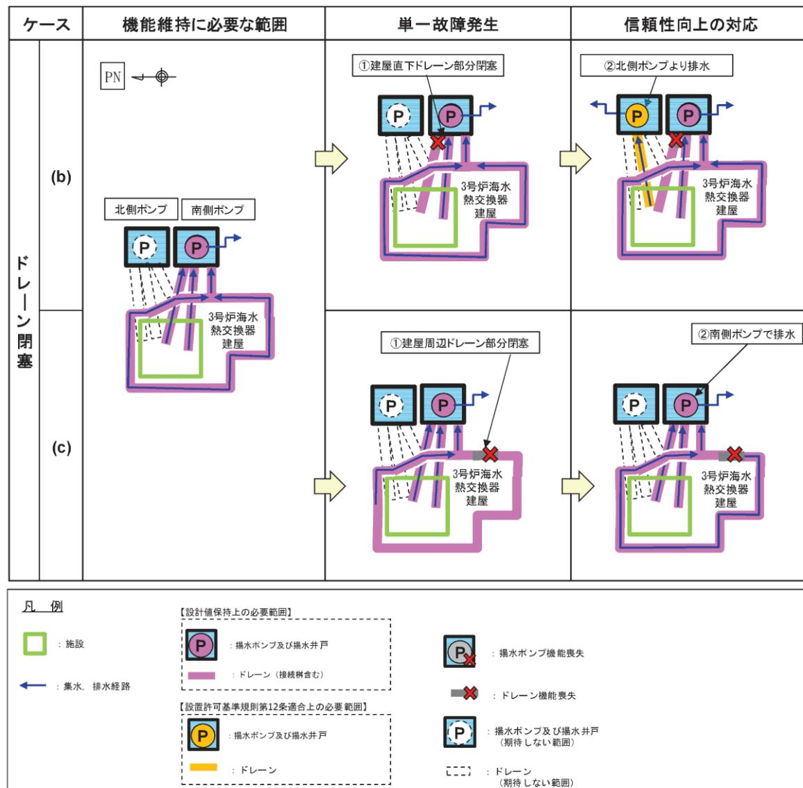
別紙18-23図 3号炉海水熱交換器建屋の設備構成検討例
