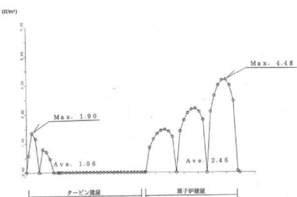
補足2-18図 揚圧力分布図及び地下水水面形(E-E'断面)
