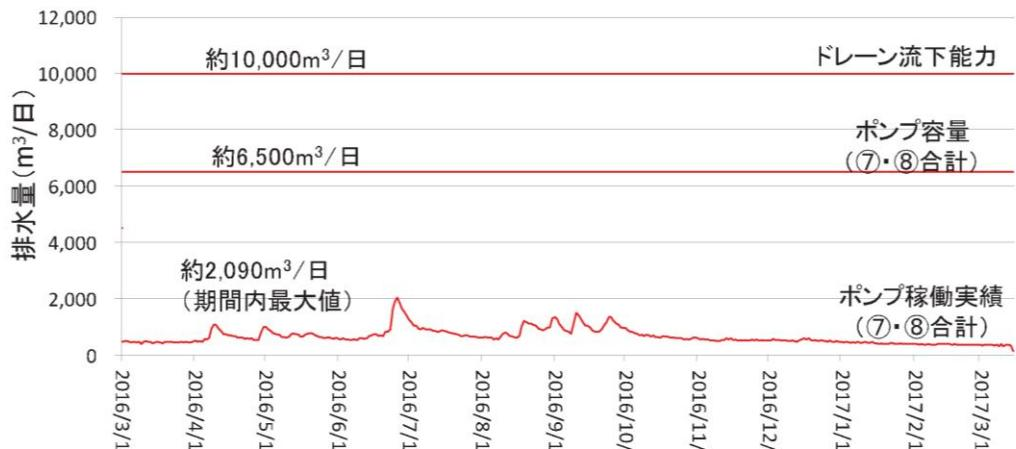
添付1-22図 ポンプ容量と稼働実績の関係(3号炉側地下水位低下設備の例)
