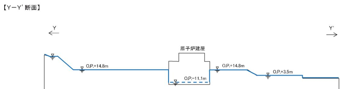
補足5-2図 原子炉建屋基礎地盤の地下水位
