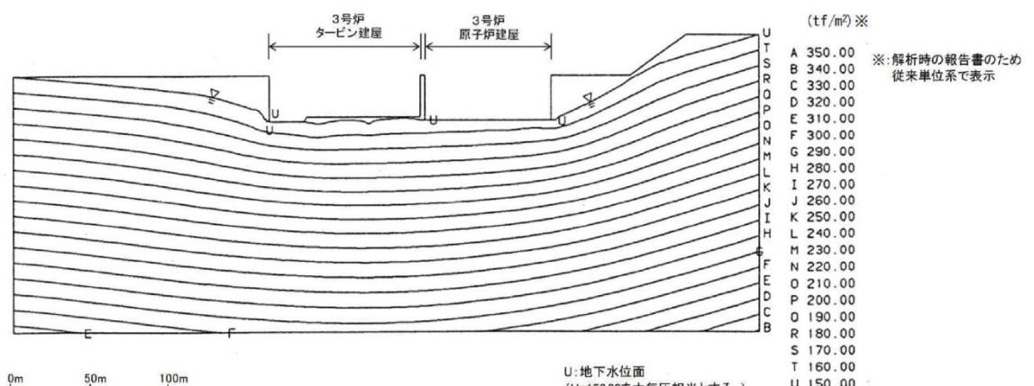
補足 2-25 図 間隙水圧分布図(E-E' 断面)
