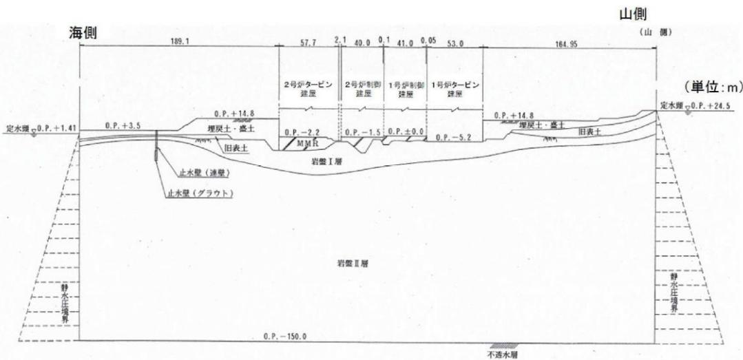
補足 2-12 図 浸透流解析断面図(B-B' 断面)
