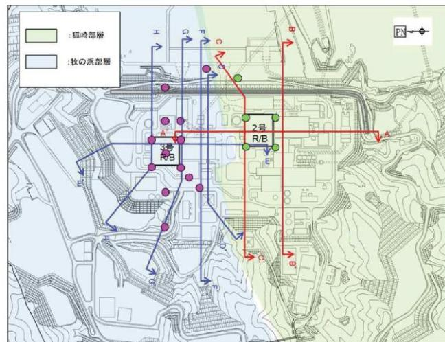
補足2-5図 岩盤の透水試験位置
