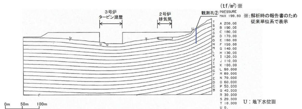
補足 2-23 図 間隙水圧分布図(D-D' 断面)
