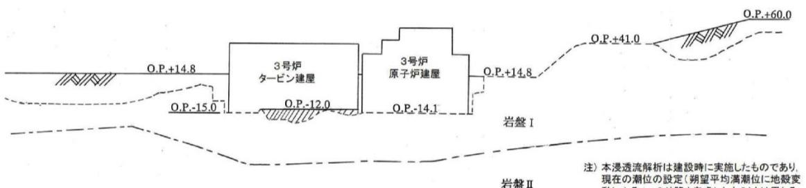
補足 2-24 図 浸透流解析断面図(E-E' 断面)
