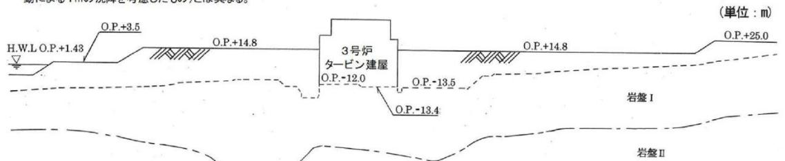
補足 2-26 図 浸透流解析断面図(F-F' 断面)
