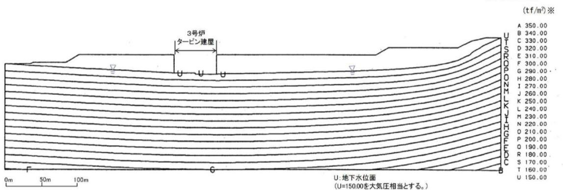
補足 2-27 図 間隙水压分布図(F-F' 断面)
