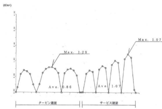
補足 2-20 図 揚圧力分布図及び地下水水面形(G-G'断面)
