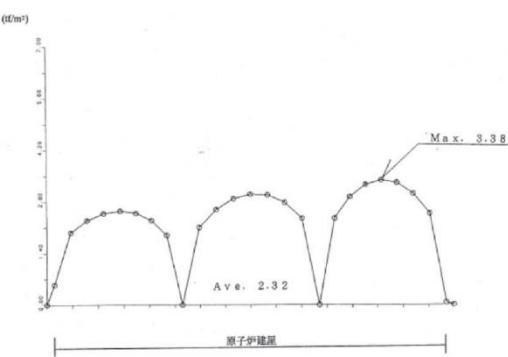
補足 2-19 図 揚圧力分布図及び地下水水面形(F-F'断面)
