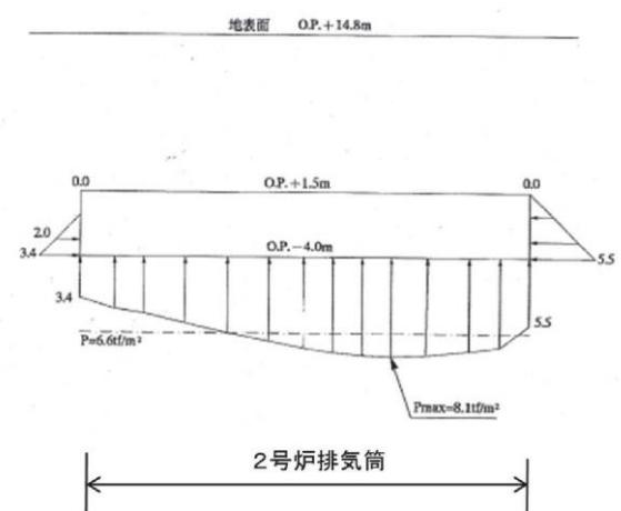
補足2-17図 揚圧力分布図及び地下水水面形(D-D'断面)
