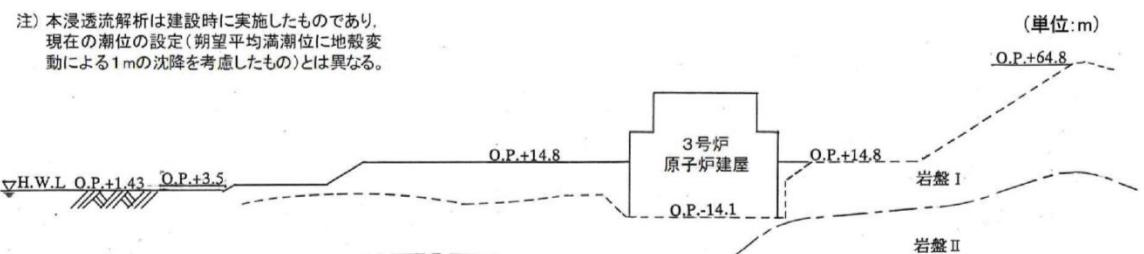
補足 2-30 図 浸透流解析断面図(H-H' 断面)
