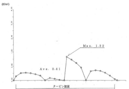
補足 2-21 図 揚圧力分布図及び地下水水面形(H-H'断面)
