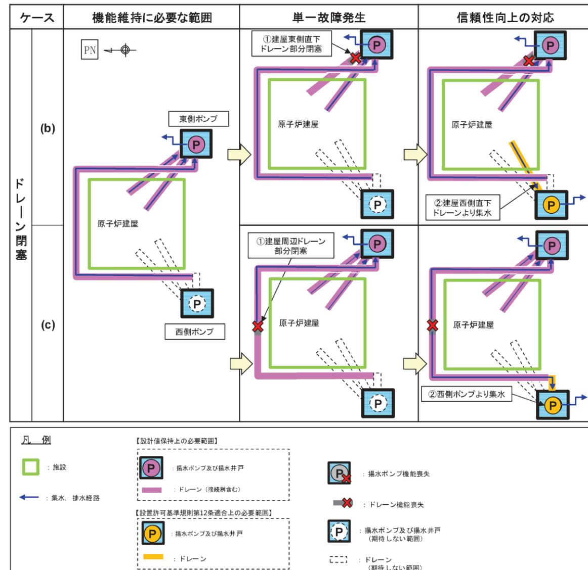
別紙18-17図 原子炉建屋の設備構成検討例
