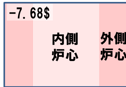
Na喪失、温度2800°Cとする。全炉心のボイド反応度とドップラー反応度によって-7.68$になる。
