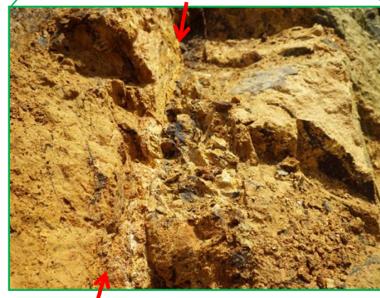
e断層の走向傾斜はN35E70Nであり、部分的に風化変質により軟質化した箇所が認められる。
