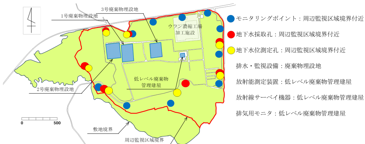
第1図 1号、2号及び3号廃棄物埋設施設の監視測定設備の設置箇所概略図（埋設する放射性廃棄物の受入れの開始から覆土完了まで）
