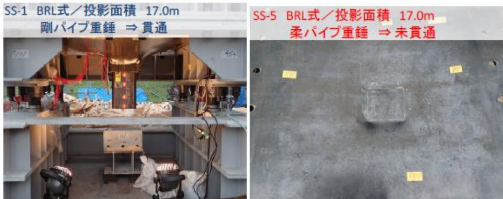
第 8 図 試験後の試験体鋼板の状況（参考文献(2)より）
