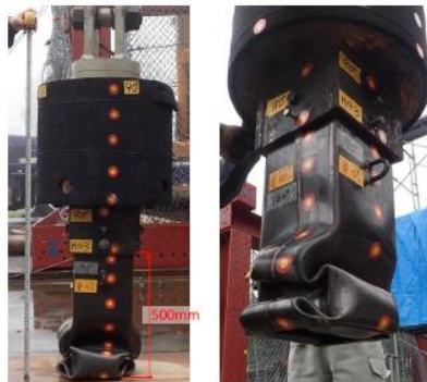
第 9 図 試験後の柔パイプ重錘の変形状況（参考文献(2)より）
