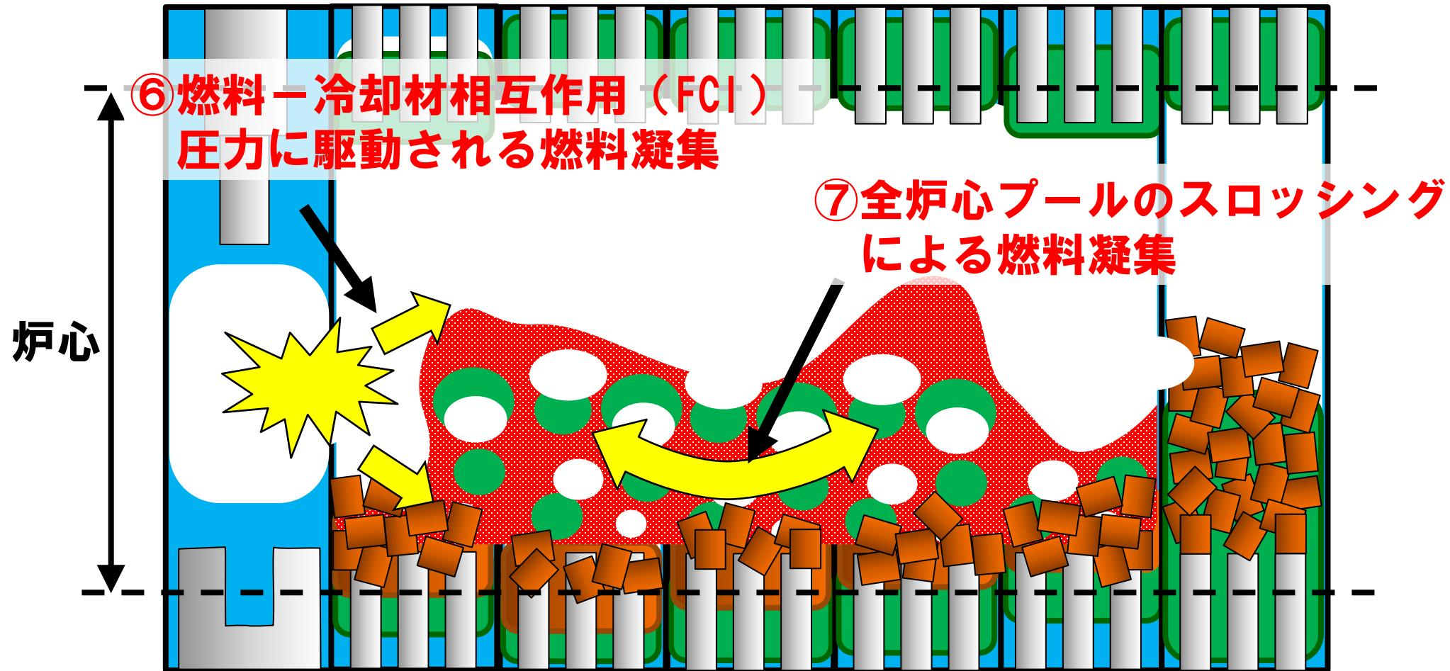
⑥ 基本ケースの即発臨界超過の直前（約131秒）で、炉心物質を炉心中心に吹き寄せる2カ所の位置（右図赤丸）にある制御棒下部案内管におけるFCIの同時発生を仮定した。過去に実施されたナトリウムを用いたFCI実験の最大圧力が約40atmであるところ、約80atmの圧力が発生する量のナトリウムを強制的に炉心物質に混合させた。
