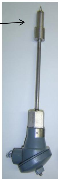
【通電式ナトリウム漏えい検出器（リボン型）】
