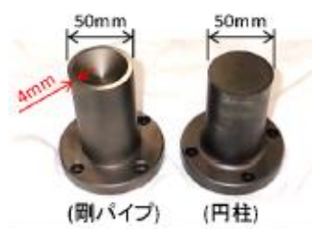
第3図 飛翔体の衝突部形状（参考文献(1)より）
