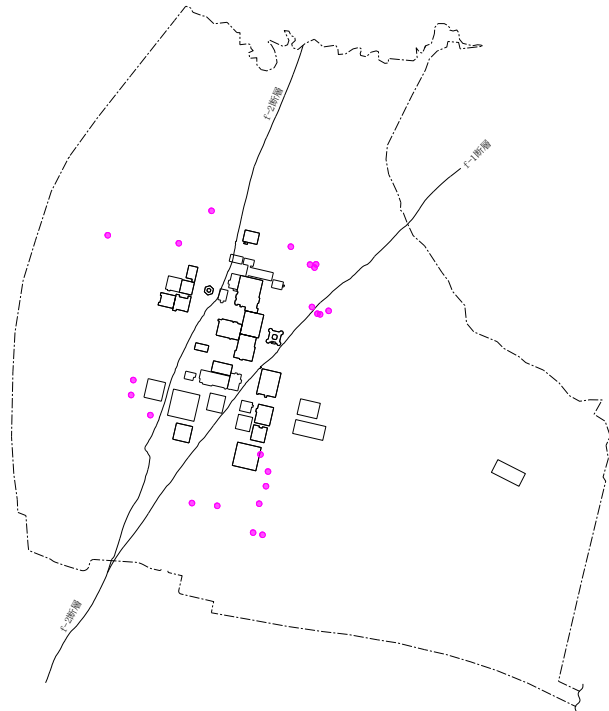
造成盛土の物性値算定に用いるボーリング調査孔位置
