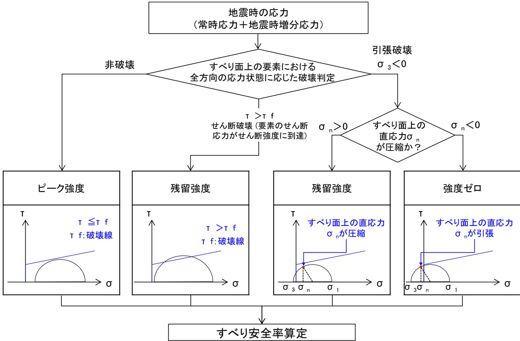
・地盤の強度特性については、すべり面上の要素の応力状態に基づいて設定する。
