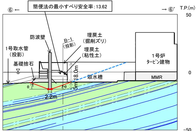
※ 消波ブロック, 被覆石, 捨石, 施設護岸及び基礎捨石は施設としてモデル化していない。
