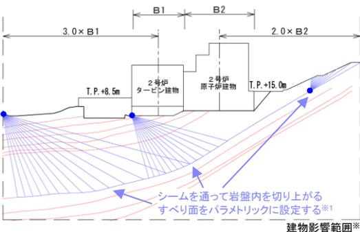
シームを通過して岩盤内を切り上がるすべり面をパラメトリックに設定する。<sup>※1</sup>
