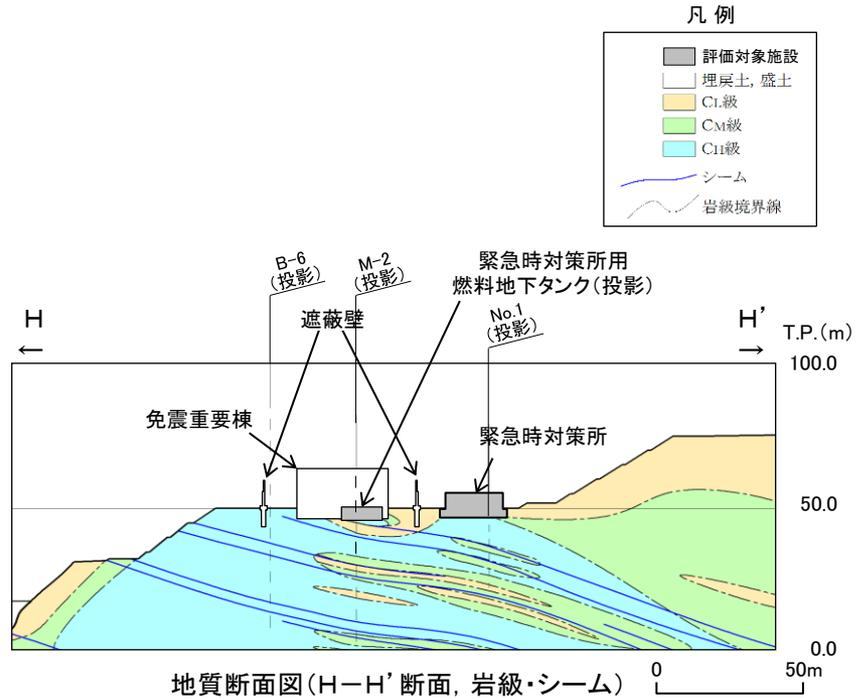
地質断面図(H-H'断面, 岩級・シーム)
