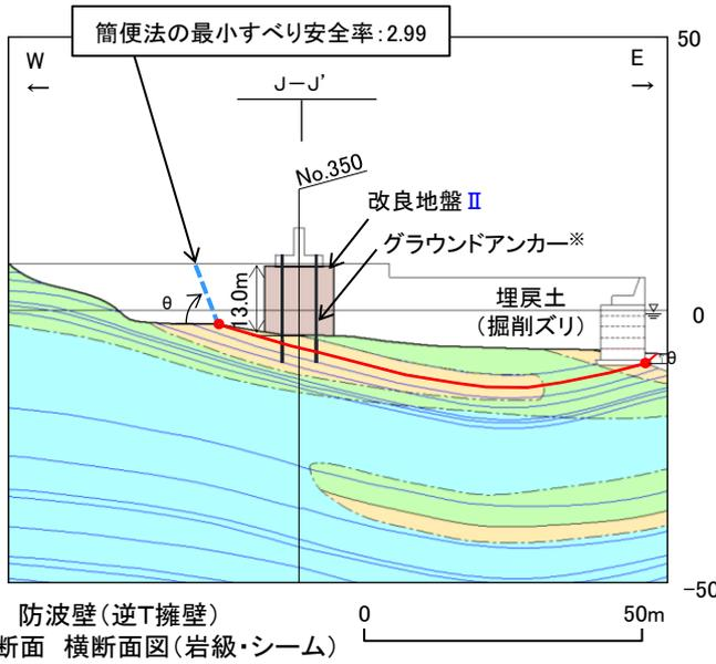
※ グラウンドアンカーはモデル化せず、安全率算定時にグラウンドアンカーによる緊張力を考慮する。
