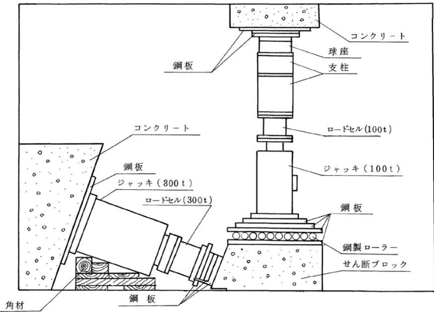
ブロックせん断試験装置概要図
