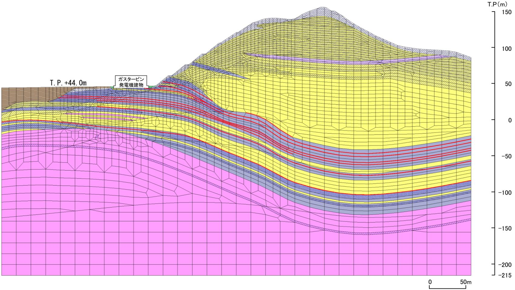
解析用岩盤分類図(防波壁(多重鋼管杭式擁壁) ⑦-⑦' 断面)
