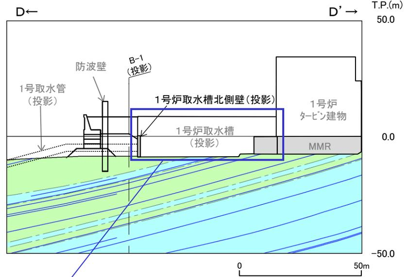
地質断面図(D-D'断面, 岩級・シーム)
