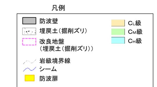
※1 図中の [ ] については、地盤改良を実施しているが、元の埋戻土(掘削ズリ)の分布を示すために、改良前の地質状況を示している。
