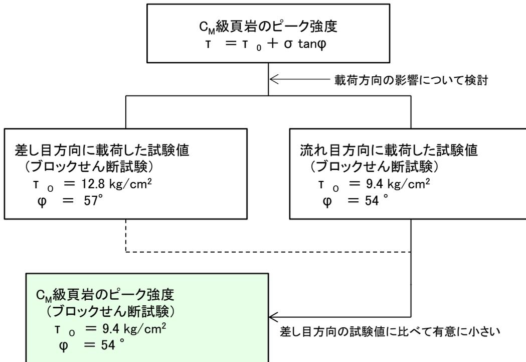
・流れ目方向に荷重した試験値は、差し目方向に荷重した試験値に比べて有意に小さい。
