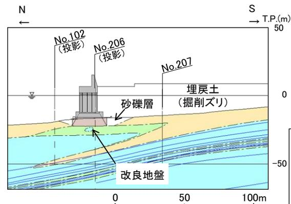
防波壁(波返重力擁壁)地質断面図
