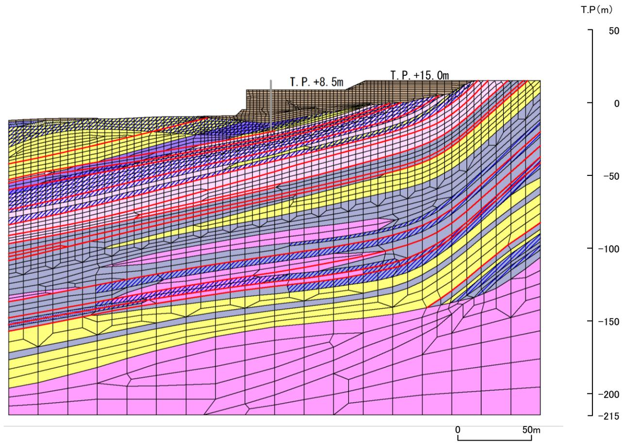
解析用岩盤分類図(防波壁(逆T擁壁) ⑪-⑪' 断面)
