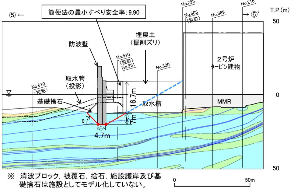
※ 消波ブロック, 被覆石, 捨石, 施設護岸及び基礎捨石は施設としてモデル化していない。
