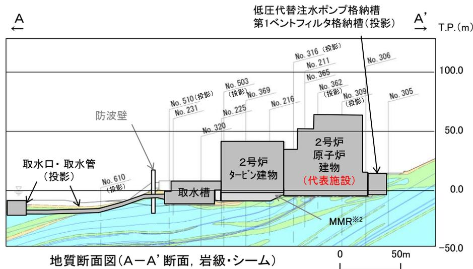
地質断面図(A-A' 断面, 岩級・シーム)
