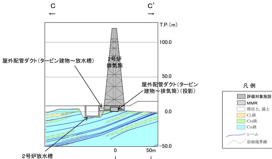
地質断面図(C-C' 断面, 岩級・シーム)
