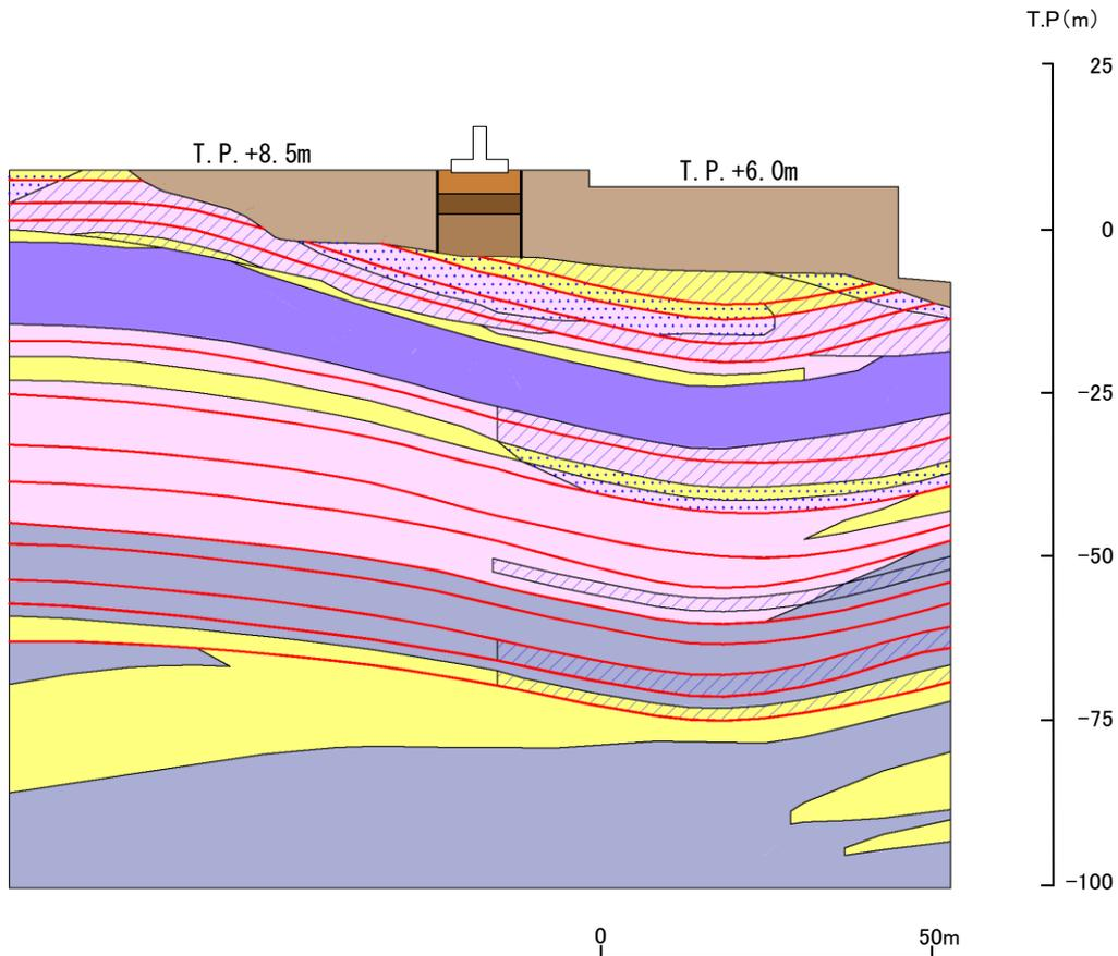
解析用要素分割図(防波壁(逆T擁壁) ⑪-⑪' 断面)
