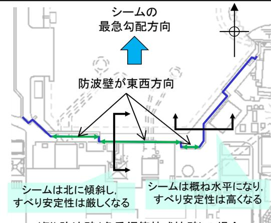
(例)防波壁(多重鋼管杭式擁壁)の場合
