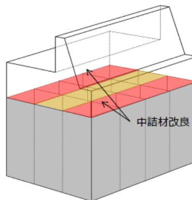
ケーソン(輪谷部)耐震補強対策工(例)
