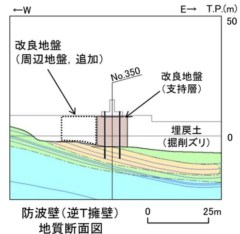
防波壁(逆T擁壁)地質断面図
