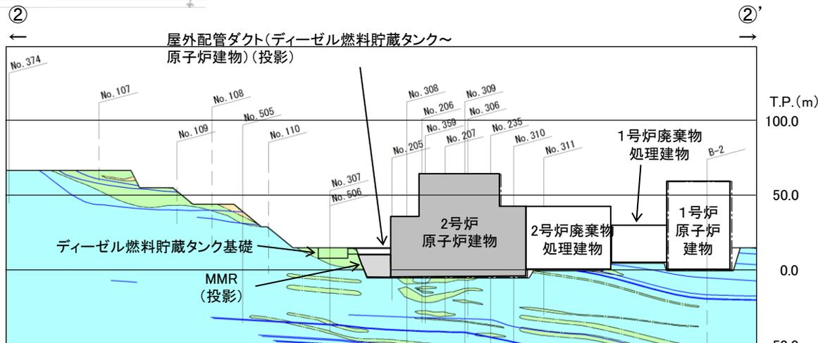
地質断面図(②-②'断面, 岩級・シーム)
