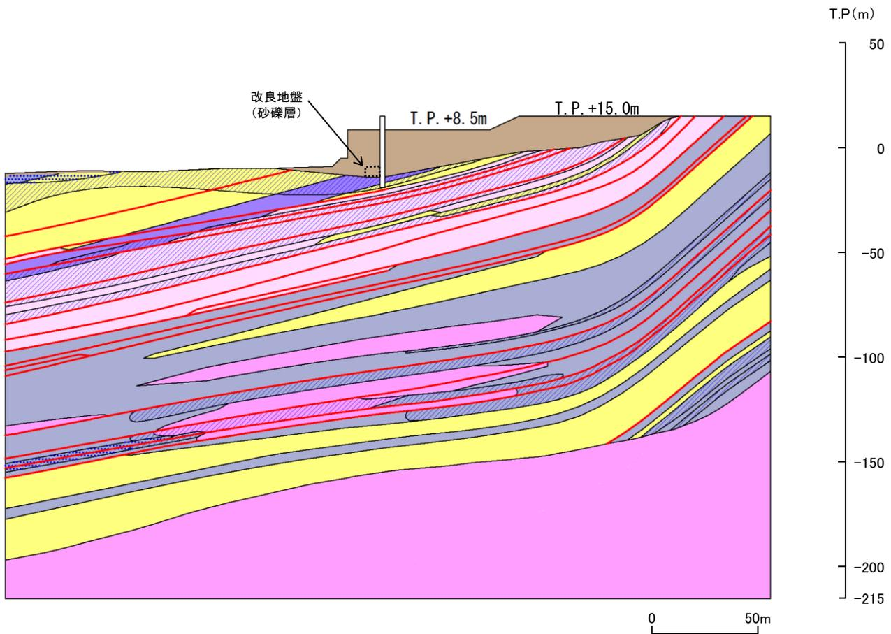
解析用要素分割図(防波壁(多重鋼管杭式擁壁) ⑦-⑦' 断面)
