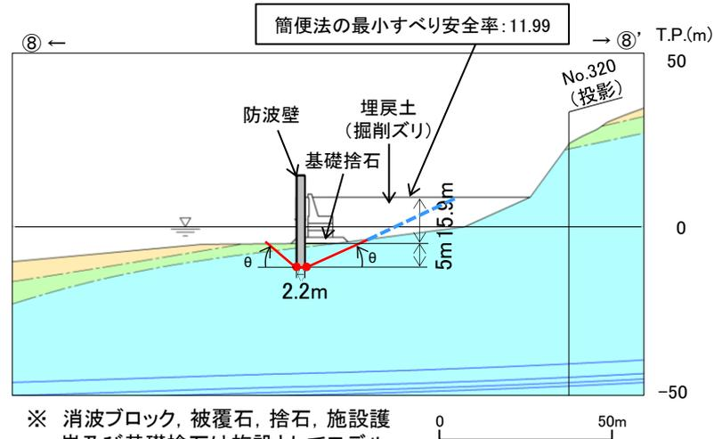
※ 消波ブロック, 被覆石, 捨石, 施設護岸及び基礎捨石は施設としてモデル化していない。
