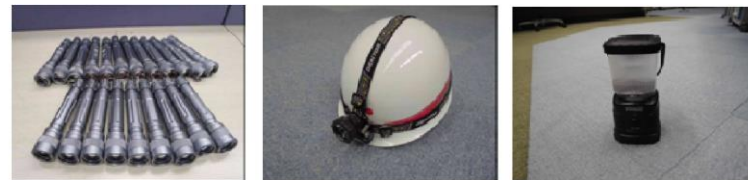
中央制御室における照明の確保 (例)
