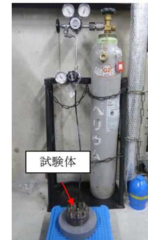
第 41 図 He 気密確認試験状況
