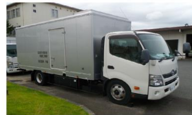
可搬型代替低圧電源車
