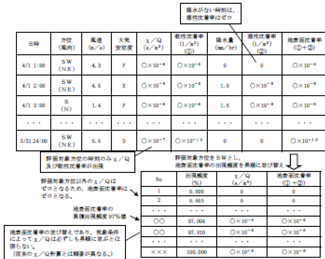
第2図 地表面沈着率の累積出現頻度 97%値の求め方 (評価対象方位がSWの場合)
