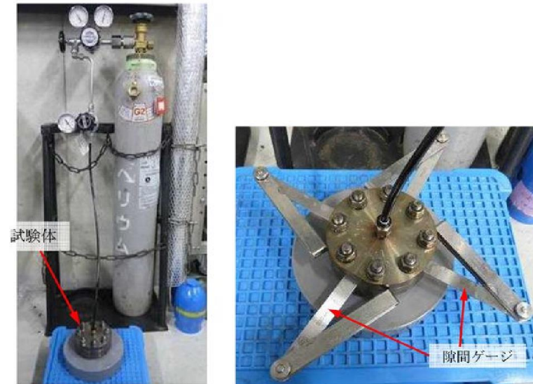
第5図 He気密確認試験状況 第6図 開口模擬したHe気密試験 (隙間ゲージ使用)
