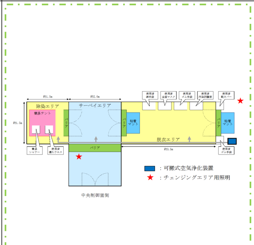
図 3.3-3 中央制御室チェンジングエリア
