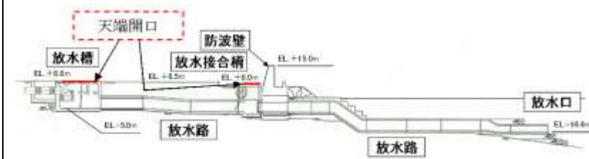
第 2.2-25 図 3号炉 放水施設の断面図
