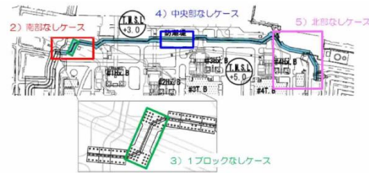
添付第 4-27 図 各検討ケースの防潮堤損傷状態
