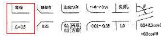
第3-3 図 入口形状と損失係数 (土木学会水理公式集(平成11年版) p.375)
