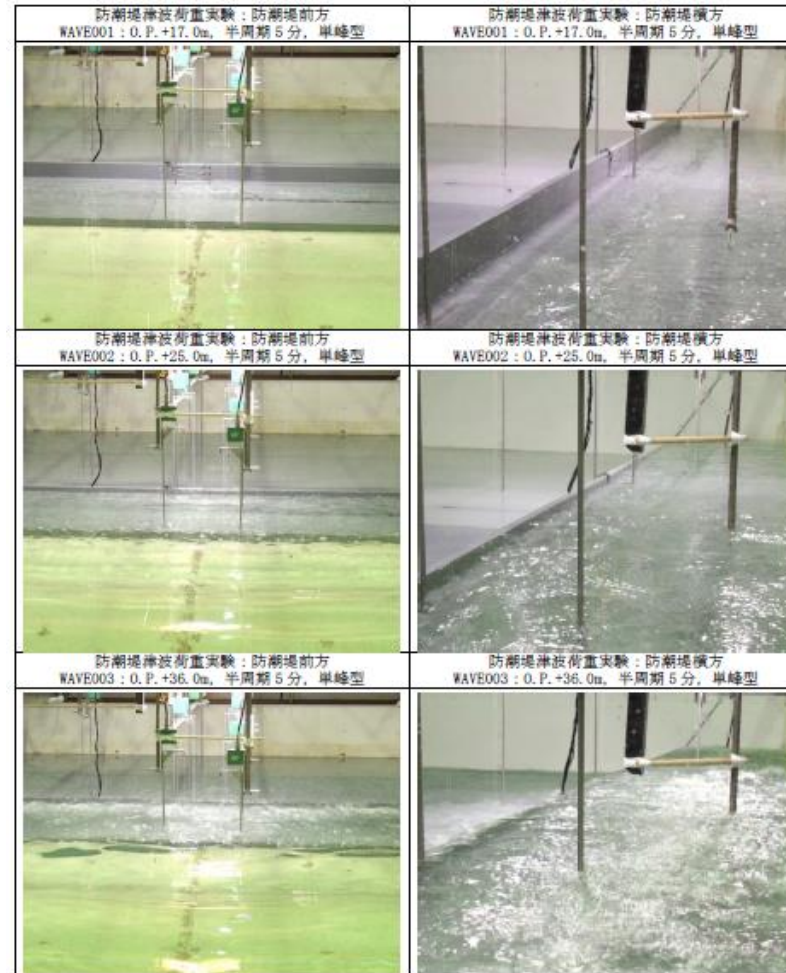
写真 2-1 実験状況 (津波荷重実験)
