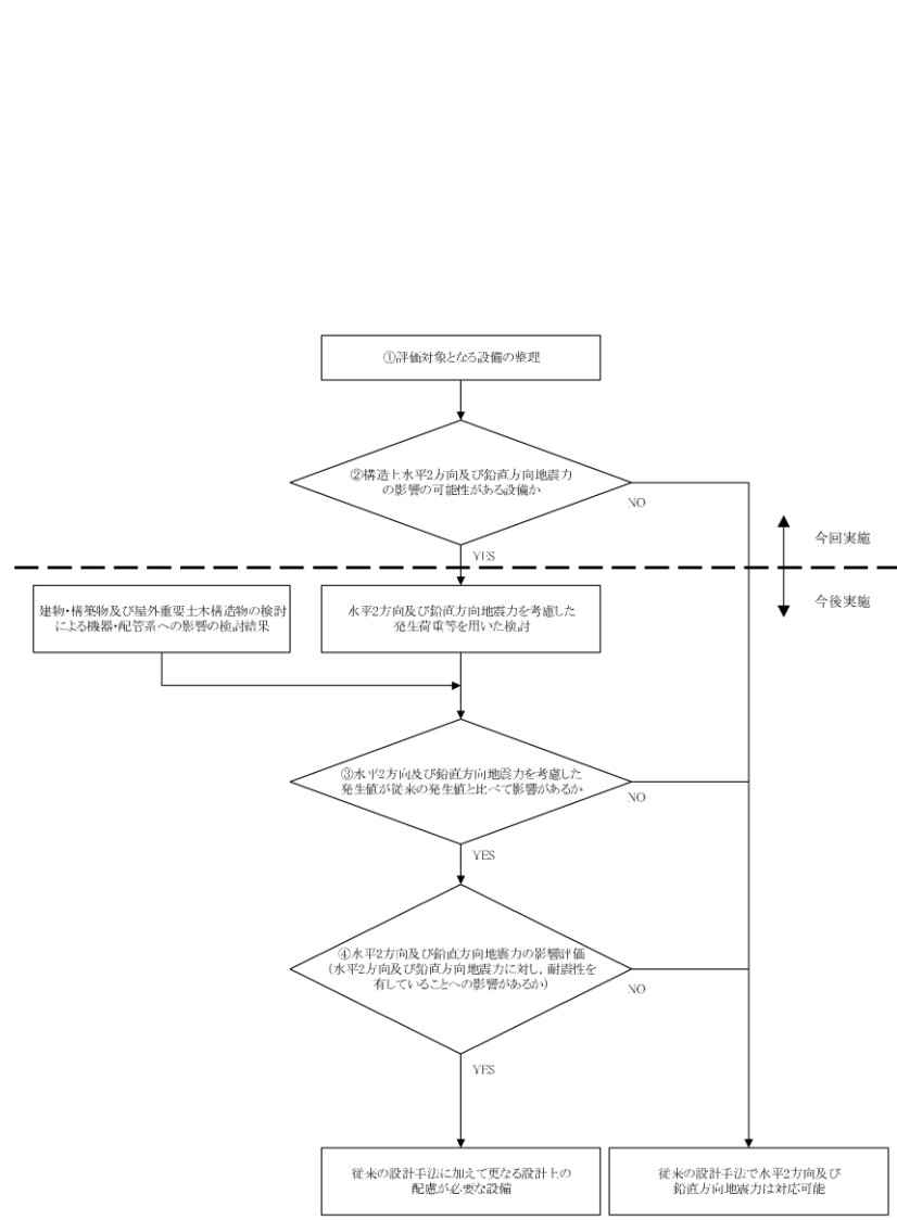
第3.2.3-1図 水平2方向及び鉛直方向地震力の組合せを考慮した影響評価フロー
