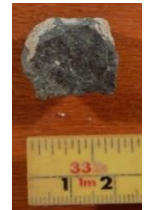
①試料採取箇所(基部) 泥岩
