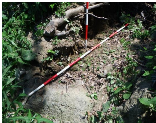
P3 谷筋の露頭 礫質土及び凝灰岩・火山礫凝灰岩 (2019年8月21日撮影)
