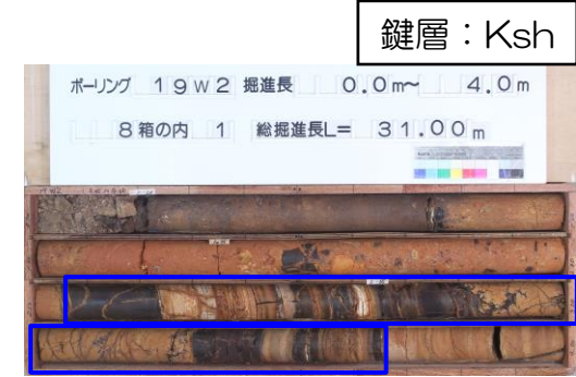
19W2孔コア写真(G.L.0.0~4.0m) 鍵層: Ksh 黑色頁岩を主体とし、凝灰質頁岩と互層をなす。 ドレライト岩床を伴う場合あり。層厚約1~1.5m。
