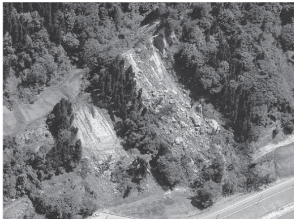
写真2: シルト岩～砂質泥岩と細粒砂岩の互層から成る斜面で発生した浅層並進岩すべり(大八木ほか(2008)より引用)
