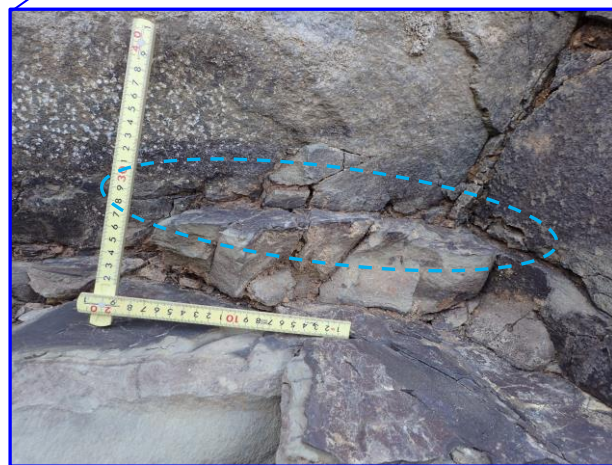
凝灰岩露頭 割れ目なし (2019年11月6日撮影)
