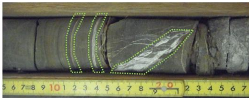
試料採取位置例 (No. 124 ボーリングコア) (GL-40.10~40.20m)
