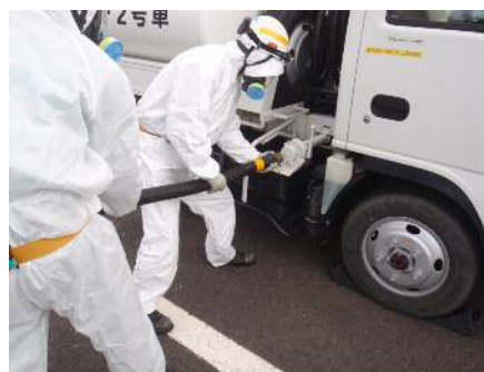
タンクローリへのホース接続
