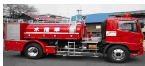
第2図 小型動力ポンプ付水槽車
